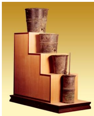
元朝复式沉箭 式铜壶滴漏
